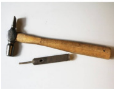
Hammer og betonbor.
