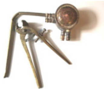
Rørtråd og monteringsdåse i messing fra omkring 1920. samt rørtrådstang.
