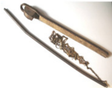
Bøjeklods til stålrør og bøjefjeder til plastrør.
